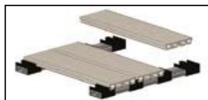
sottostruttura in alluminio
